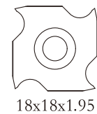
刀具類型:KC3.01 / Groover: KC3.01 捨棄式刀片類型 / Carbide Inserts Knives 組合示意圖 / Sectional View
